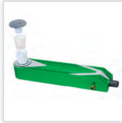
Zypho to rekuperator, który przekazuje ciepło z wody z prysznicza, na zimną, która przechodząc przez rekuperator dochodzi do baterii prysznicza wstępnie ogrzana, znacznie redukując ilość energii potrzebnej do podgrzania lub pobór ciepłej wody. ZYPHO ogrzewa wodę na zasadzie pracy bierniej, urządzenie nie potrzebuje kompletnie żadnego zasilania ani jakiegokolwiek energii, a zwrot inwestycji następuje po 2-3 latach.
